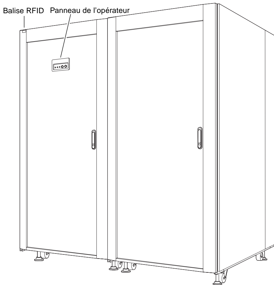
FIGURE 1-3 Serveur M9000 (avec une armoire d'extension)
