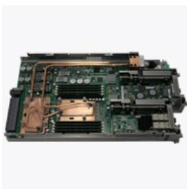
計算に必要なデータや計算した結果を、ラック外部にある記憶装置とやり取りするためのIOシステムボードが6枚搭載されています。
