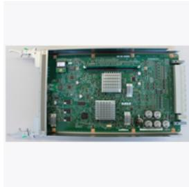
サービスプロセッサボードは、ラックの制御を行うボードです。システムボード等の初期化や、エラー・故障等の異常監視をしています。信頼性を高めるため、二重化されており、ラックに2枚搭載されています。
