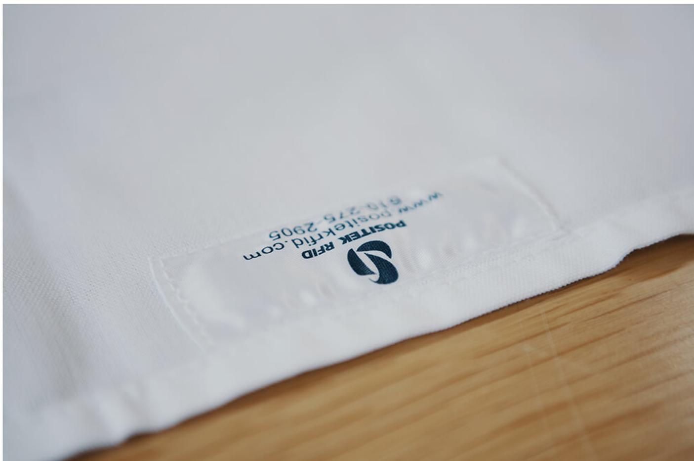
RFIDはリネンの折り返しの部分に入れ込むか、上から布を被せて縫い付けて装着する。
