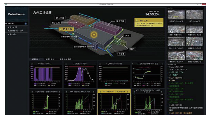
「Intelligent Dashboard」を採用した「D's FEMS」の大画面表示。工場内では70型タッチモニターで表示されている
