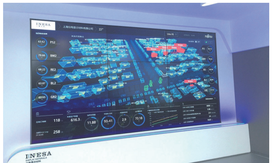
工場全体の製造ラインの稼働状況を可視化したIntelligent Dashboard （場所：INESA Display Materials Co., Ltdのカラーフィルター製造工場内 中央管理室）
