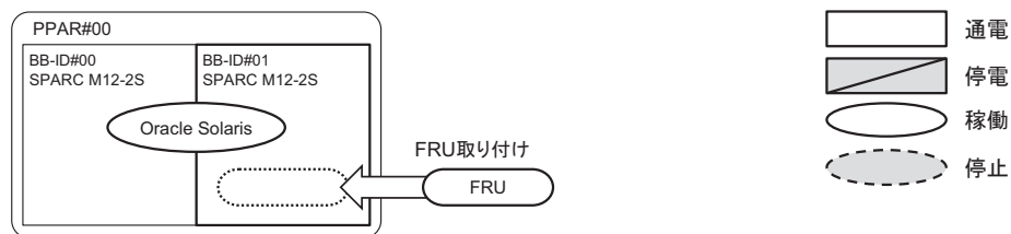
図 3-32 SPARC M12-2S（複数BB構成）での活性／通電増設
