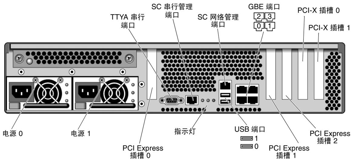
图 4 SPARC Enterprise T2000 服务器后面板
