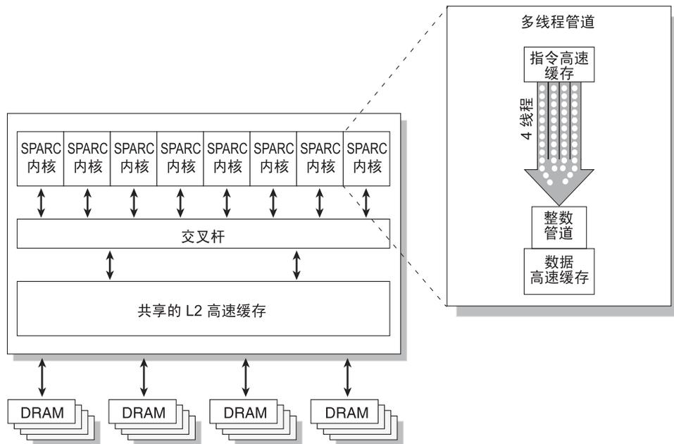
图 2 UltraSPARC T1 多内核处理器框图
