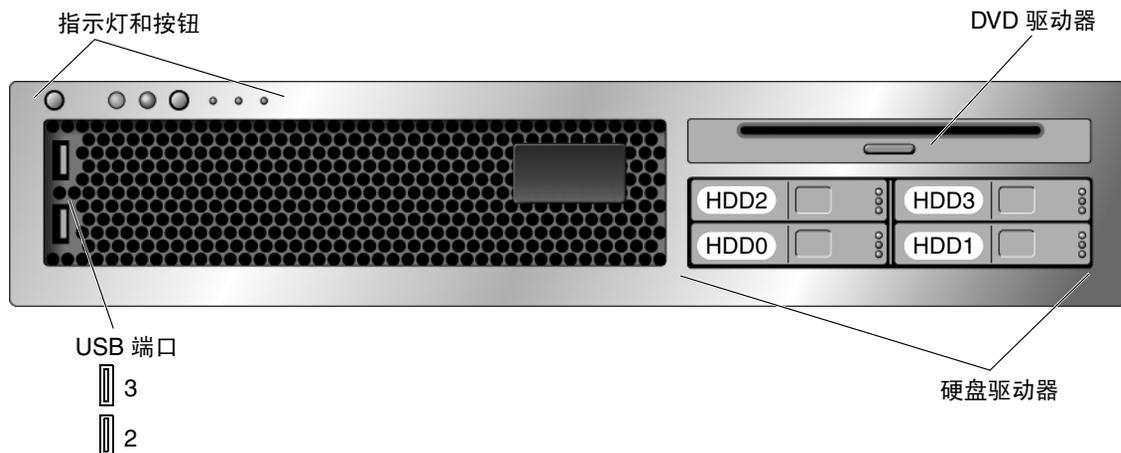
图 3 SPARC Enterprise T2000 服务器前面板
