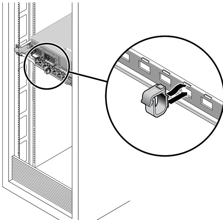
图 2-22 安装或移动电缆夹
