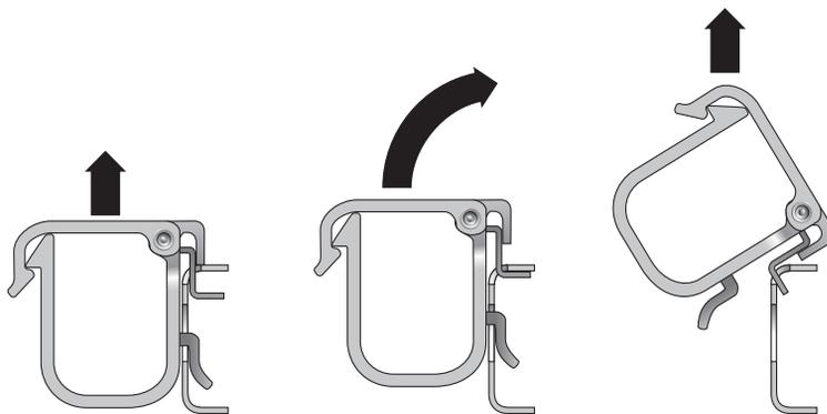
图 2-21 拆除电缆夹
