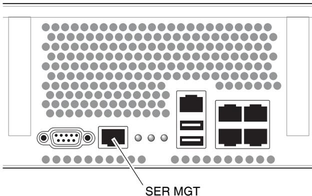
图 2-17 系统控制器串行连接
