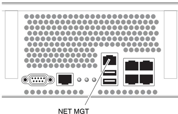
图 2-18 系统控制器网络连接
