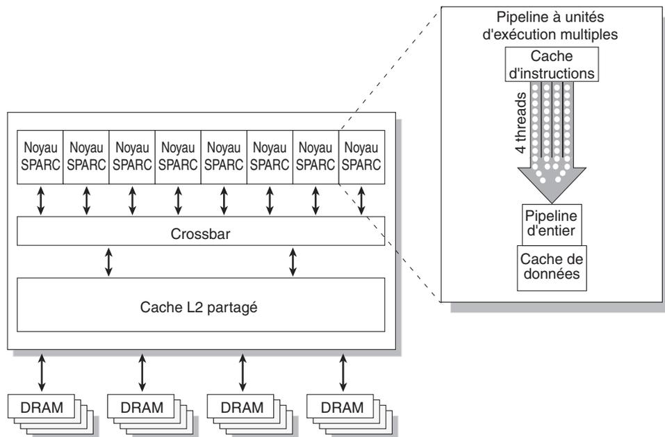
**FIGURE 2** Diagramme des blocs d'un processeur multinoyau UltraSPARC T1
