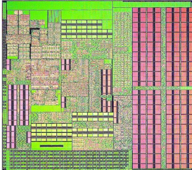
**Figure 13 SPARC64 V (130nm process) Die Photo**
