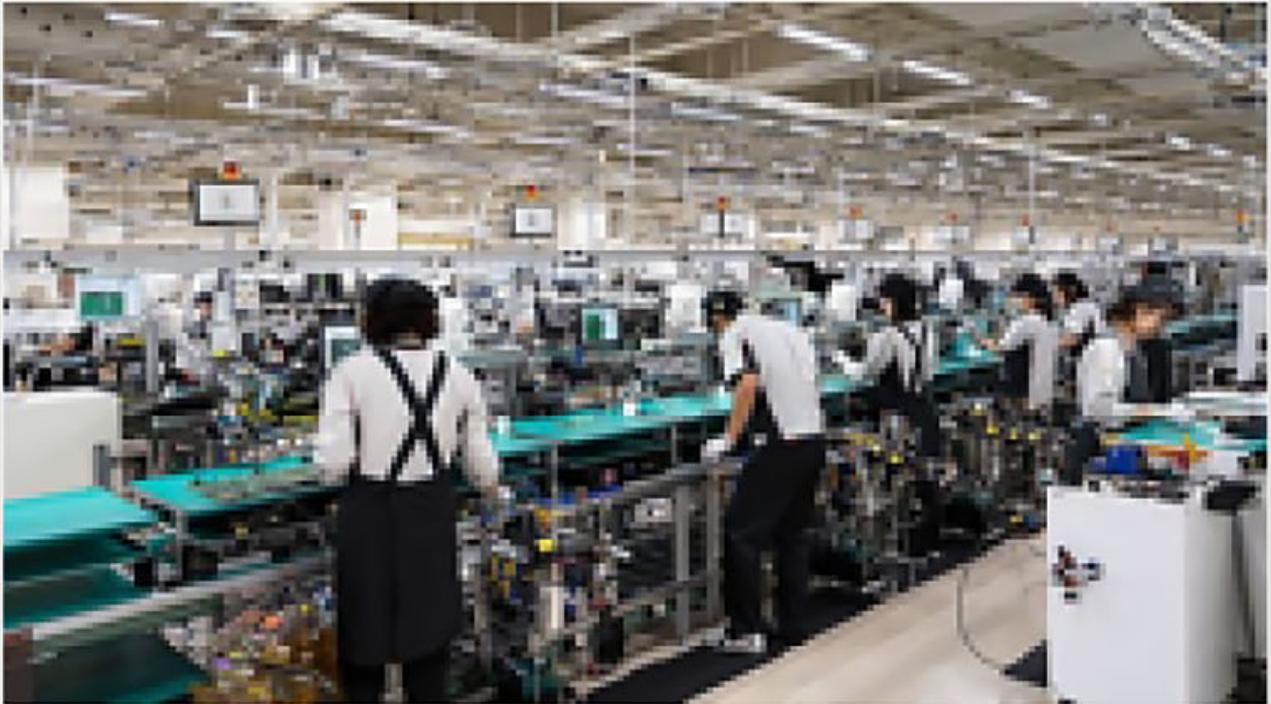
組立作業をカメラで撮影し、作業内容を高精度に検知。高精細映像から現場作業の実態を見える化、抜け漏れを警告することで、従来は人に頼っていたチェックをテクノロジーに置き換え
