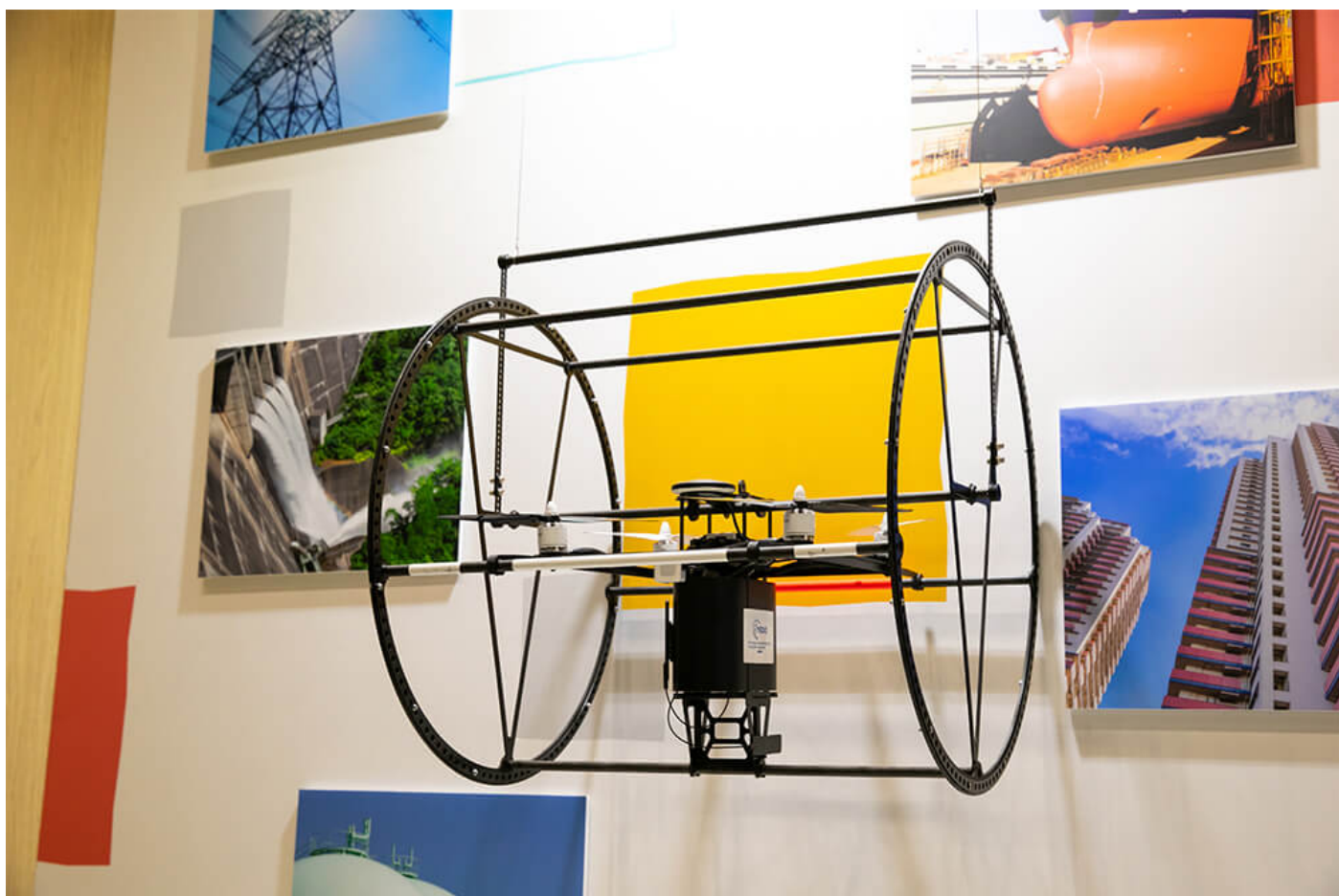
車輪を搭載した二輪型の点検ドローンでより正確に記録
