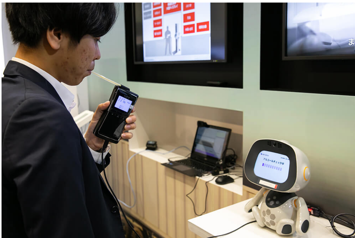
点呼支援ロボット「Tenko de unibo」によりアルコールなどの呼気をチェック
