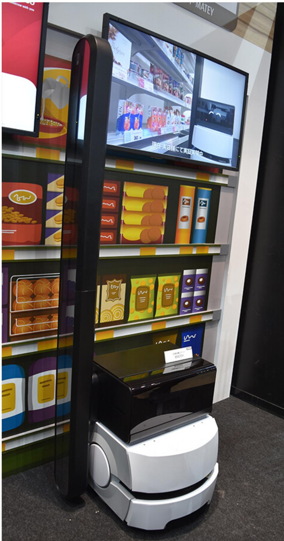
各種センサーやカメラを搭載した自立走行ロボット
