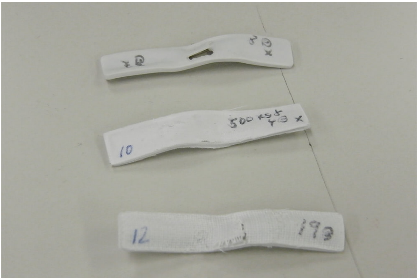
開発中に擬似圧力脱水の試験で壊れたサンプル
