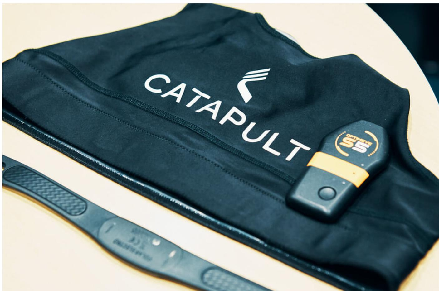
川崎フロンターレが使用しているスポーツブラ型のIoTデバイス。背中ポケットに小型のGPSを固定し、胸下部分に心拍計バンドを差し込んで使用する。
