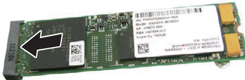
図 9.4 M.2 SSDの取付け
