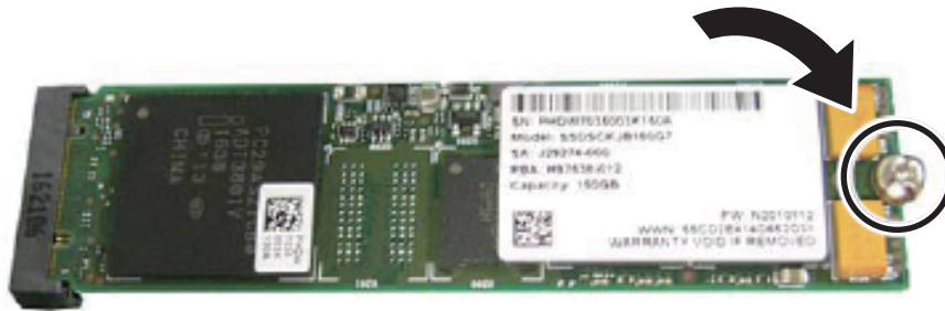
図 9.5 M.2 SSDの固定
