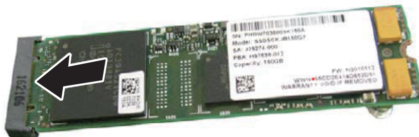
図 9.4 M.2 SSDの取付け
