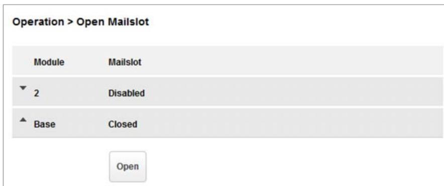
メールスロットを開くには、該当するメールスロットの [Open] をクリックします。ライブラリのロックが解除され、メールスロットをライブラリから引き出して取り扱えるようになります。
