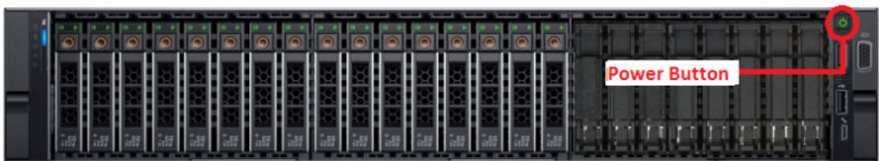
図 2.21 コントローラー部の電源投入
