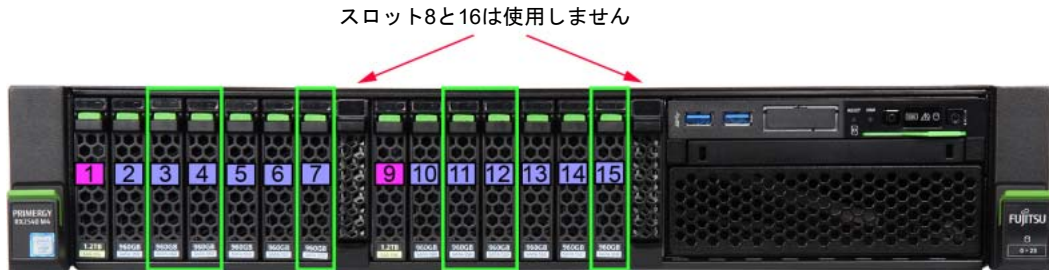
図 13.15 SSD を搭載する HDD スロット
