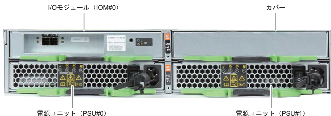
図 2.22 Entry 拡張ストレージ部の I/O モジュール
