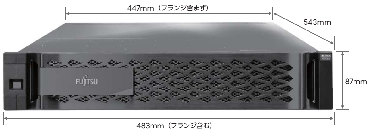
図 1.2 コントローラーシェルフ（2.5インチ用）寸法図（ETERNUS AX2200）
