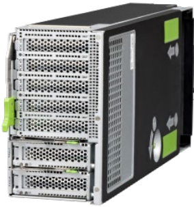
I/Oユニット
