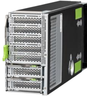
I/Oユニット
