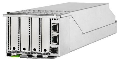
I/Oユニット
