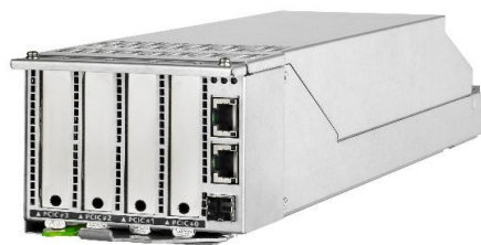
I/Oユニット
