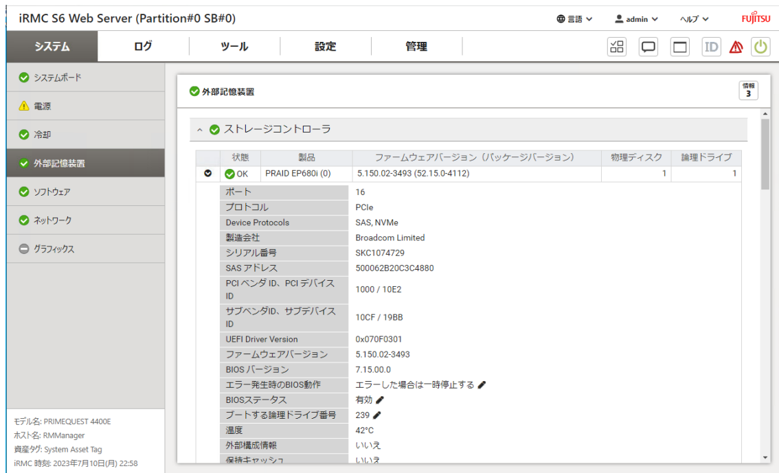
図 16: ストレージコントローラの詳細
