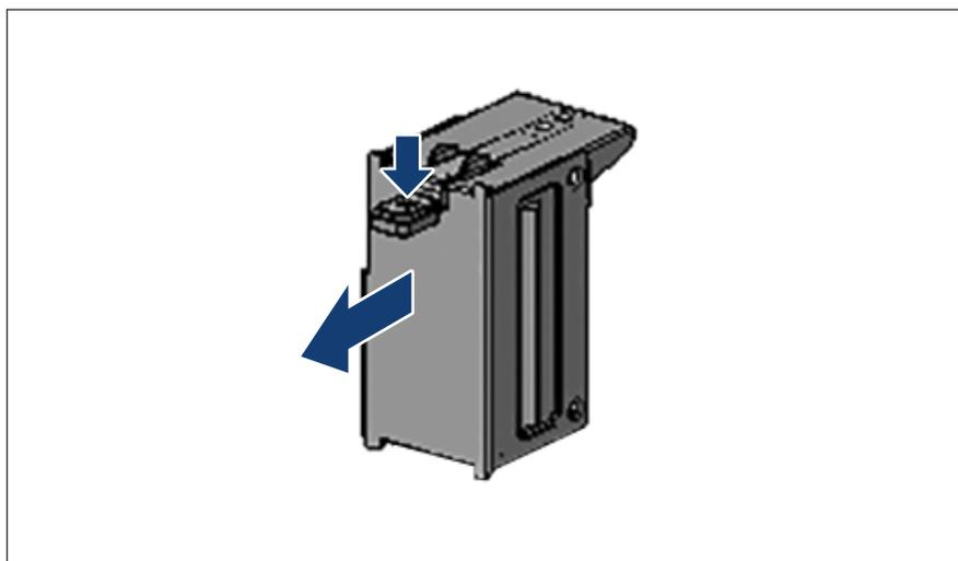
図 39: ダミーカバーの取り外し
