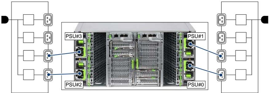
図 12: AC 冗長構成の PSU 冗長 (2+2) の配線図
