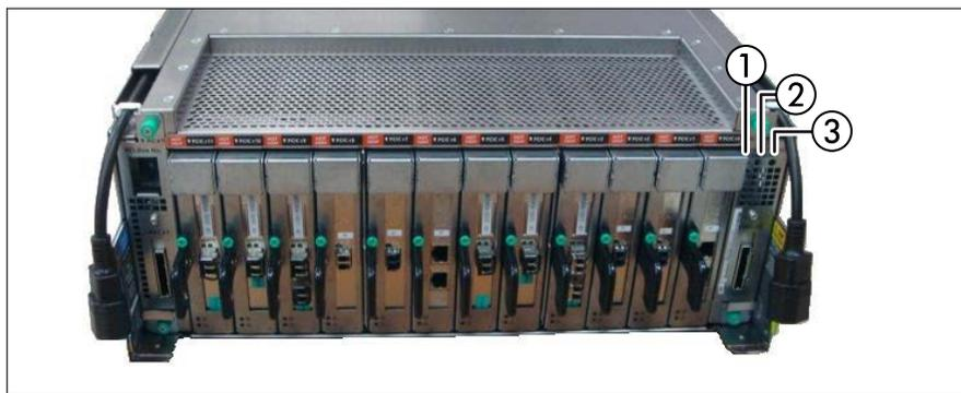
図 29: PCI\_Box の表示ランプ
