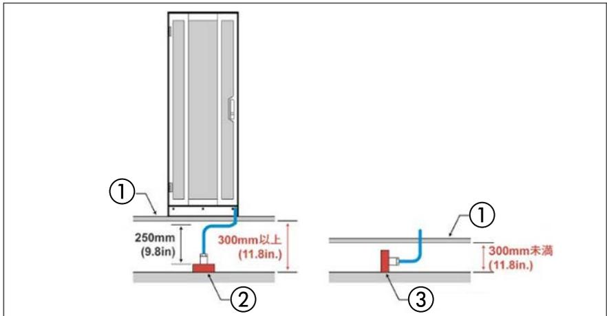
図 16: 上げ床の下の電源ケーブルの接続
