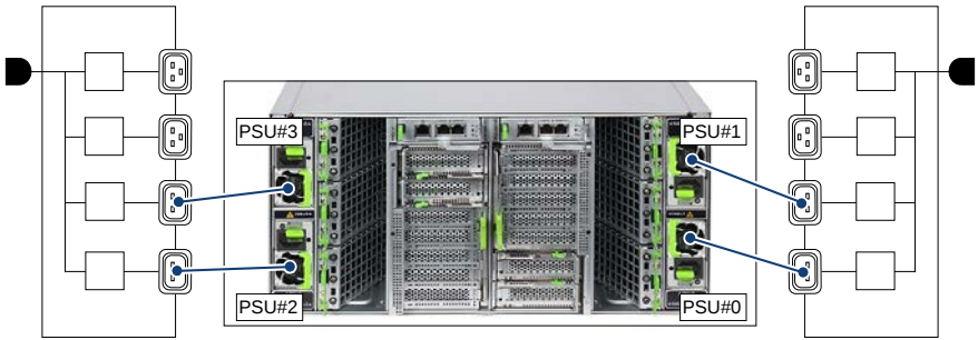
図 12: AC 冗長構成の PSU 冗長 (2+2) の配線図
