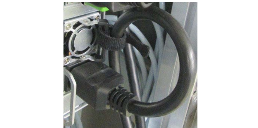
図 15: 電源コードを固定するためのケーブルクランプ
