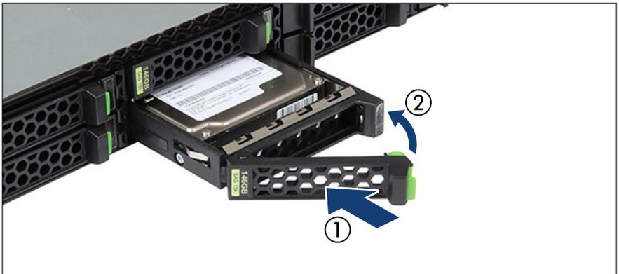
図 38: 2.5 インチ HDD/SSD モジュールの取り付け
