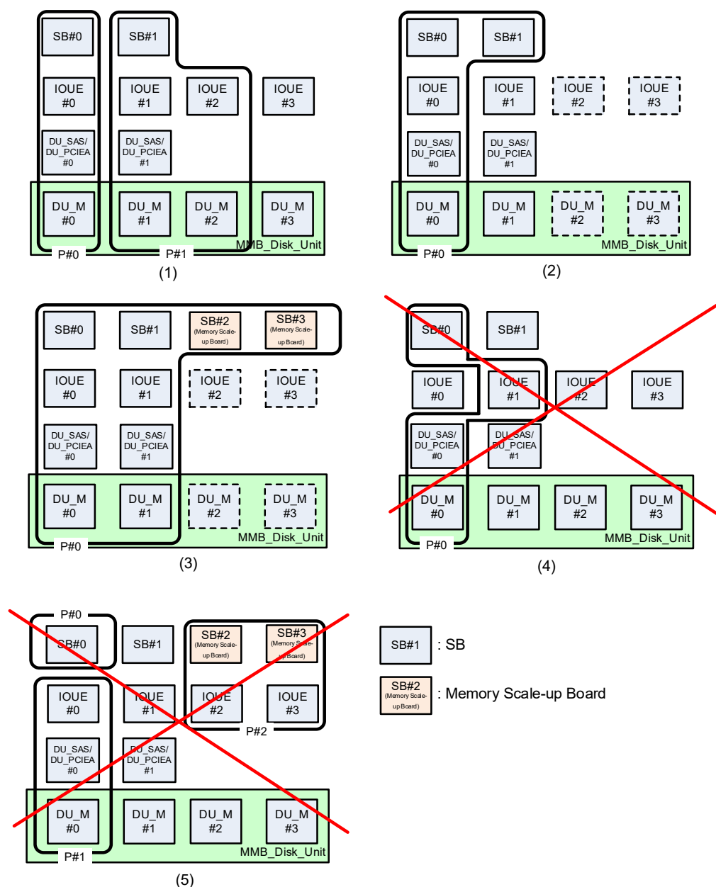
図 3.2 パーティショニング機能の概念図 (PRIMEQUEST 3400E2/ 3400L2/3400E/3400L SB 上に CPU を 2 個搭載している場合)
