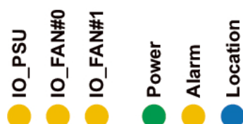
図 F.5 PCI ボックスの LED 実装位置
