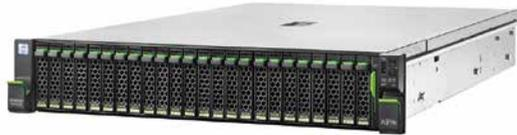
「PRIMERGY RX2540M2」は、冷却効率の高い装置設計により、最大45℃の高温度環境での動作を実現しました。例えば、発熱性の高い部品(CPU、メモリ、HDD)を冷却ファンの近くに配置するほか、冷却効率の高い電源ユニットやヒートシンクなどを採用しています。「80PLUS® Titanium」認証を取得した電源ユニットは、最大96%の電源変換効率を達成しており、AC/DC変換時の電力ロスと発熱を抑えています。また、電源内部に搭載されたファンで電源ユニットを集中的に冷却することで、装置内部の空気の流れを最適化しています。
