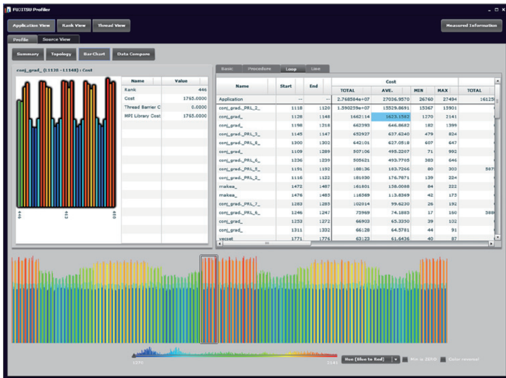
図-4 基本プロファイラによるコスト分析表示(一次元表示) 左上：プロセスごとのコスト情報(部分拡大図) 右上：プログラムループごとの性能値の一覧 下： プロセスごとのコスト情報(全体の一次元表示)
