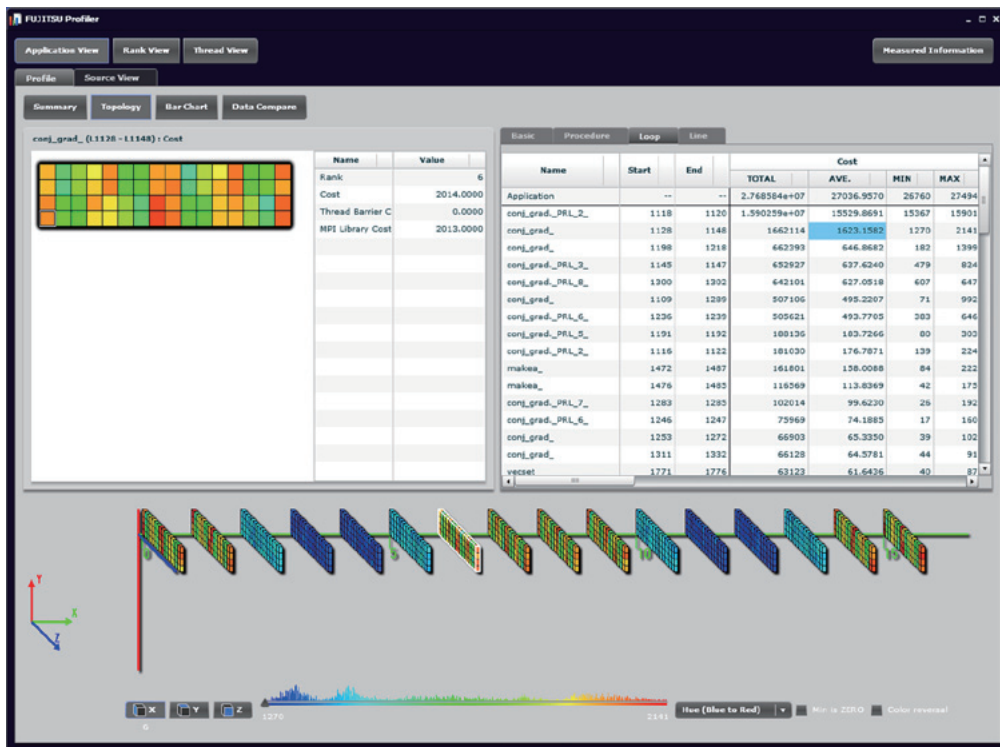
図-3 基本プロファイラによるコスト分析表示(トポロジー表示) 左上：プロセスごとのコスト情報(部分拡大図) 右上：プログラムループごとの性能値の一覧 下： プロセスごとのコスト情報(全体の3Dトポロジー表示)
