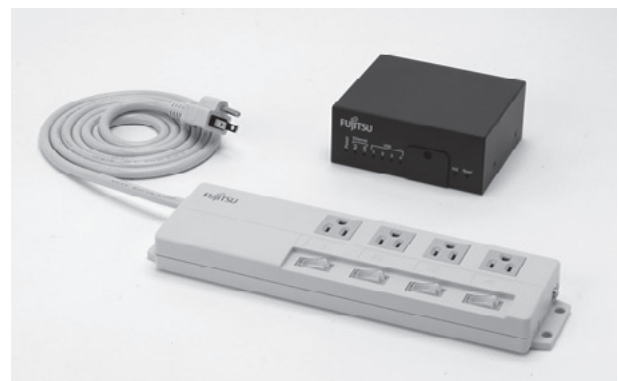
図-1 スマートコンセント Fig.1-Smart power strip.
