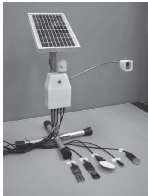
図-4 農業用センサユニット Fig.4-Sensor unit for agricultural field.
