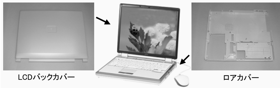
図-3 植物性プラスチックを採用したノートパソコン Fig.3-Application of bio-plastic to notebook PC housing.
