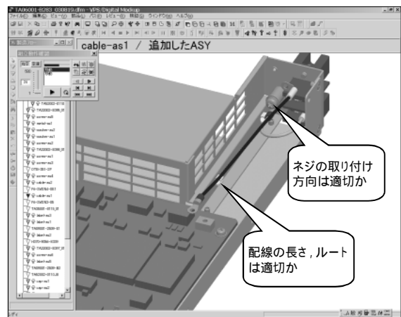
図-3 VPSを用いた組立性レビュー Fig.3-Review of assembly using VPS.
