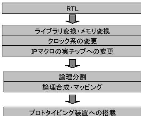
図-4 プロトタイピング装置への搭載フロー
