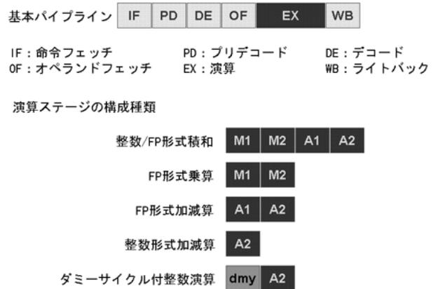
図-4 Pinoliteパイプライン構成
