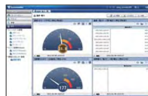
クラウド インフラ マネージメントソフトウェア 監視画面 サーバの温度・電力の監視
