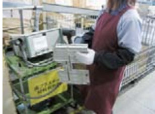
廃プラスチックの識別機
