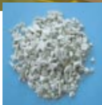
減溶された 廃プラスチック
