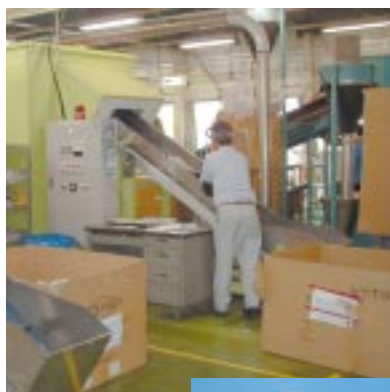
廃プラスチック減溶機
