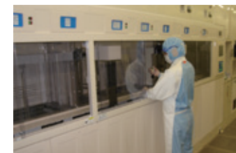
製造設備の純水ブロー量調整作業
