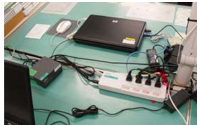
「ゲートウェイ」-「スマートコンセント」 -「ノートPC」接続状況
