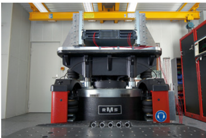
Good vibrations: Im Test-Center Augsburg müssen Server Vibrationen aushalten
