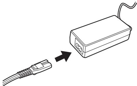
2) 把交流电适配器的接头连接到扫描仪交流电适配器接口上。
