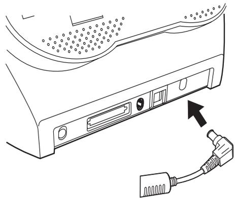
3) 把交流变压器的接头插接到电源插座上。
