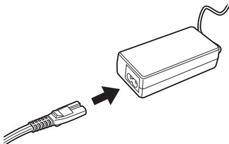
2) 把交流变压器的接头插接到扫描仪交流电源接口上。
