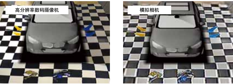
图5 与模拟摄像机的图像比较(全方位立体监视系统合成影像)
