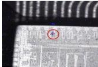
IC特性异常品的放射显微镜观察
