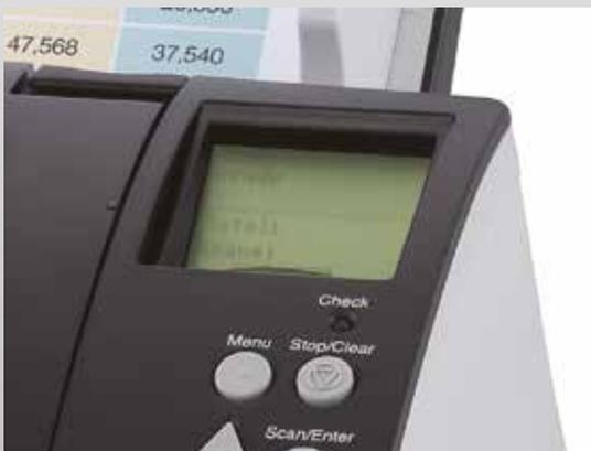
Painel de operação com tela de cristal líquido integrada
