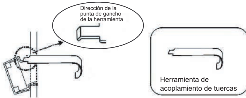
Figura 3-29 Uso de la herramienta de conexión de tuercas de jaula
