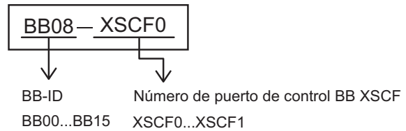
Figura 4-10 Ejemplo del aspecto de la etiqueta de un cable XSCF (SPARC M10-4S)
